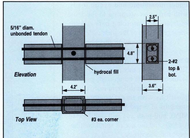
(d) Detail of post-tensioned connection
